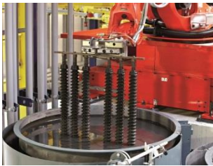
Erhitzte Kerne werden in die PVC-Paste getaucht / Les noyaux chauffés sont plongés dans la pâte de PVC
